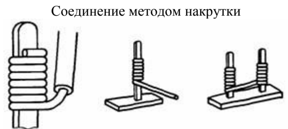
Рисунок 19 — Примеры безвинтовых соединений
