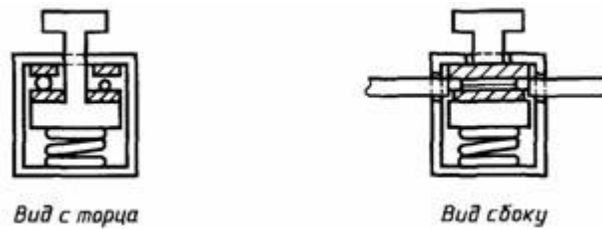
Рисунок 18 — Примеры безвинтовых контактных зажимов пружинного типа
