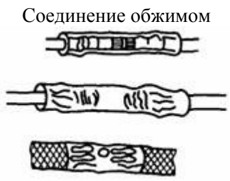
Рисунок 19 — Примеры безвинтовых соединений
