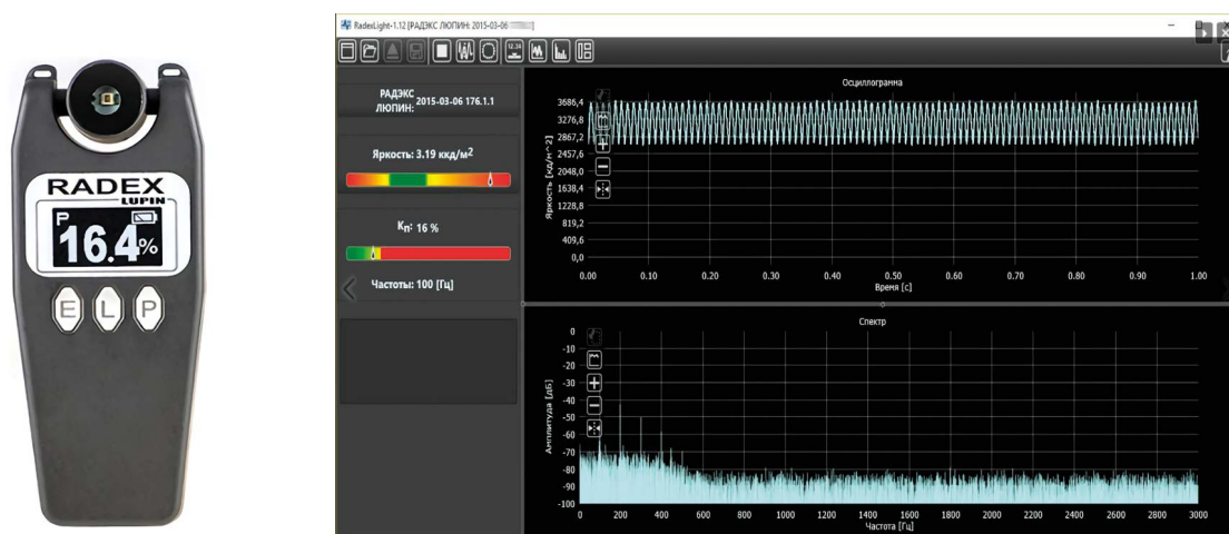
Рис. 4. Люксметр, пульсметр RADEX LUPIN и интерфейс программного обеспечения RADEXLIGHT-1.12
