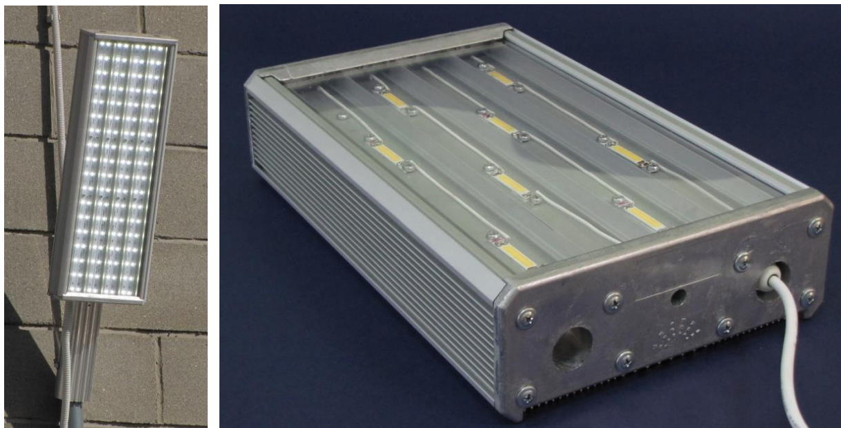
Рис. 14 Светильники уличного исполнения мощностью от 70 Вт до 105 Вт и световым потоком от 7000 Лм до 11 500 Лм. Размещение определенного количества светодиодов или светодиодных сборок при соблюдении теплового режима их работы позволяет добиться от светильника длиной 1100 мм светового потока более 20 000 Лм.
