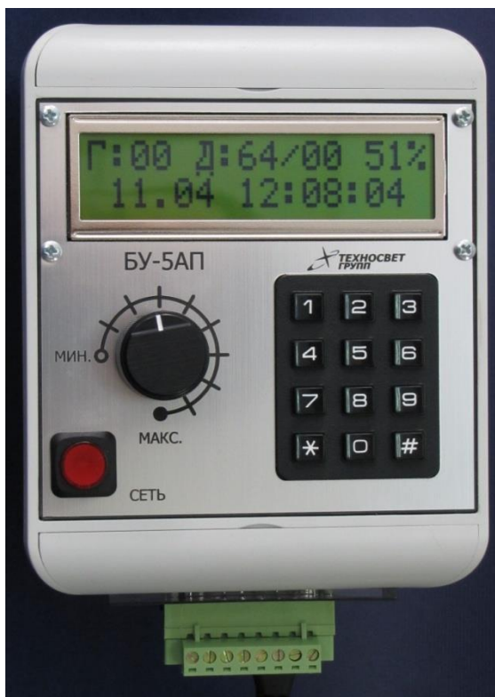
Рис. 16 Блок управления БУ-5АП. Клавиатура позволяет упростить диалог с пользователем и значительно расширить возможности контроля выполнения программы непосредственно на самом блоке. Управляющий выходной сигнал на платы в блоках сопряжения может выдаваться блоком в дискретном виде, как сегодня реализовано управление у абсолютного большинства компаний, так и кодовыми комбинациями по специальному протоколу обмена информацией, что позволяет увеличить точность управления яркостью и повысить защиту от помех.
