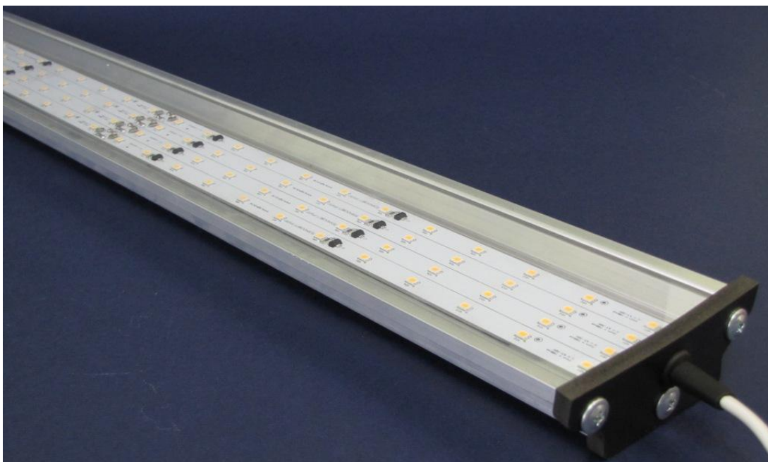
Рис. 11 Светильник SN675-48-96 мощностью 48 Вт и световым потоком 4400 Лм. Размещение определенного количества светодиодов при соблюдении теплового режима их работы позволяет добиться от светильника длиной 1000 мм светового потока равного 6600 Лм.
